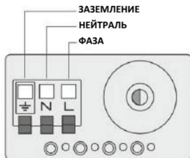
Насос должен быть заземлён. Для этого заземляющий провод кабеля, подключается одним концом к заземляющему контакту насоса, а вторым соединяется с действующим контуром заземления через вилку или фиксированным соединением.
