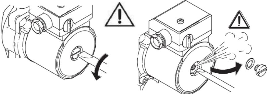
Дождитесь, пока вода из насоса будет выходить равномерно без пузырьков воздуха, затем закрутите пробку.
