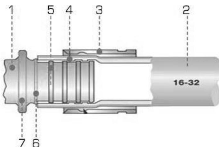
Штуцер имеет кольцевые выступы (5) для фиксации трубы на фитинге и герметизации соединения между ними, упорный буртик (6), предотвращающий осевое перемещение трубы относительно фитинга при напрессовке гильзы, воротник (7), фиксирующий конечное положение гильзы.
